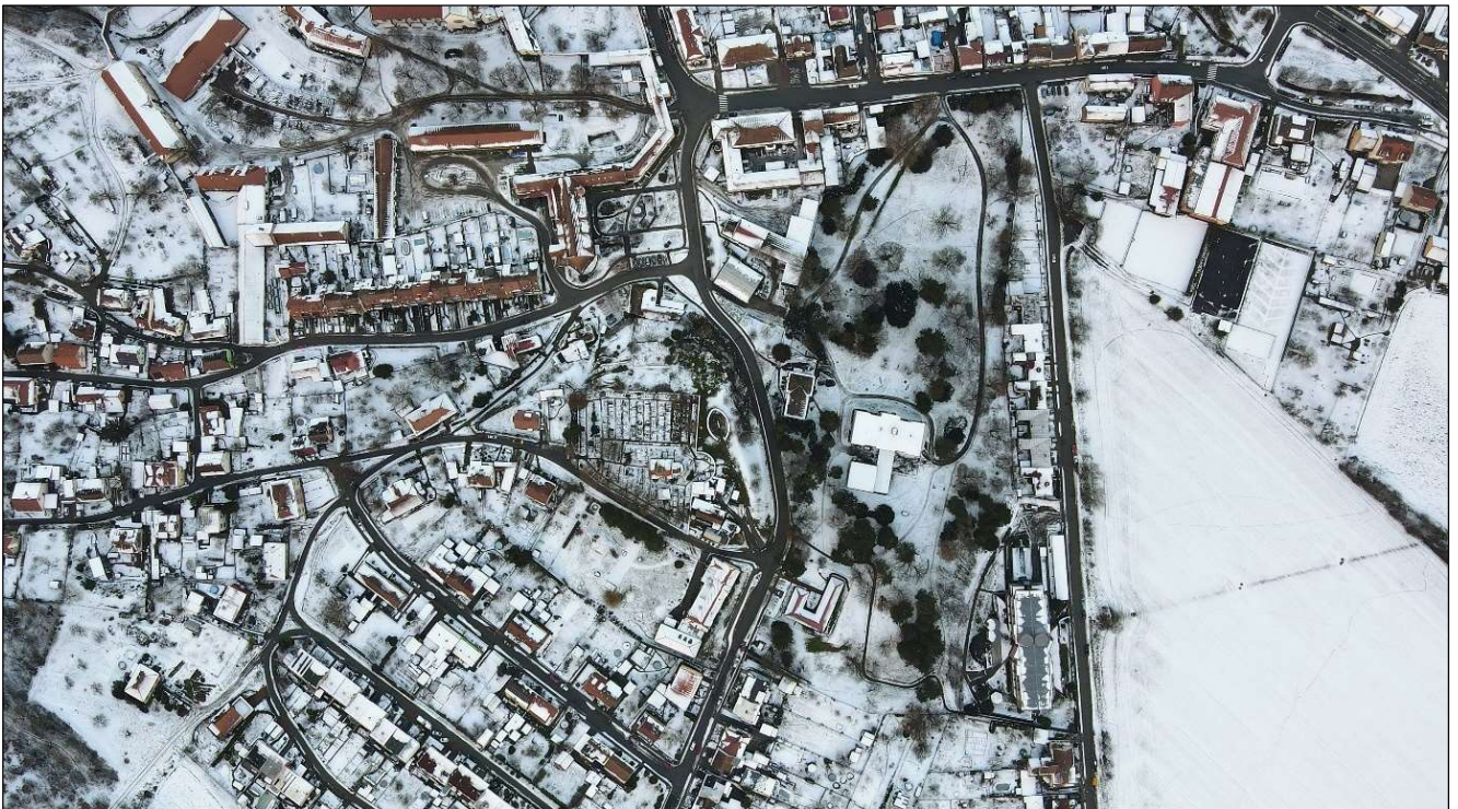
Obrázek 35: účelový ortofotosnímek v zimním aspektu území s niválním efektem ze souboru snímkování napomáhající identifikovat tepelně izolační stav střešních partií budov pro účelovou kategorizaci energetické náročnosti obytných objektů.
